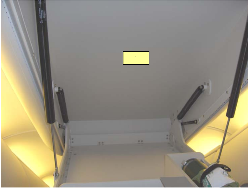
图 22：中央顶部救生船存放处一内部
