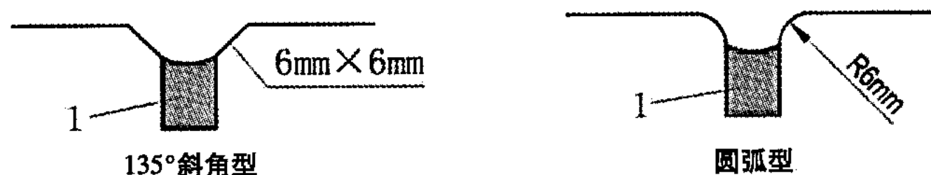
图 6.1.7 切缝倒角的尺寸要求
